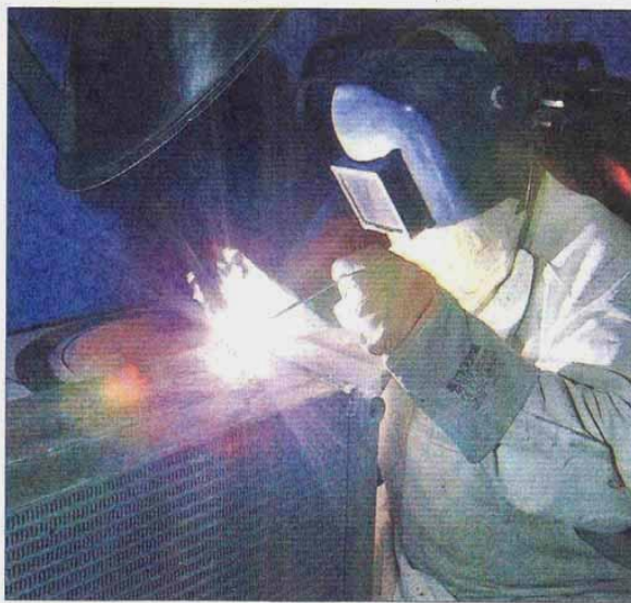
Handarbeit: Große Kühler - wie dieses Exemplar für einen Mähdrescher - müssen aufwändig von Hand geschweißt werden. Unser Foto zeigt Martin Hufnagel bei seiner Arbeit.
